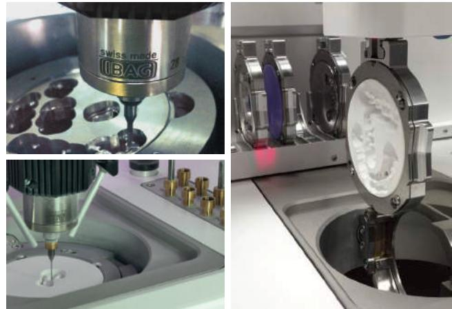
Frässystem mit 5 Achsen (5 Servomotoren für Simultanbearbeitung).
